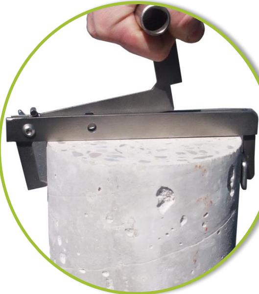
**Pour le soulèvement des éprouvettes :**
