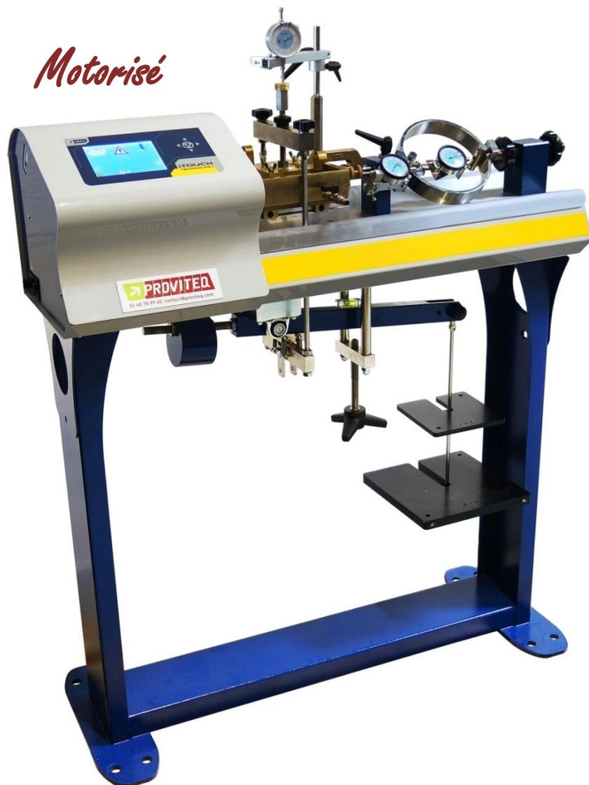
**Mesure de la résistance au cisaillement directe et alternée d'éprouvettes de sol**
